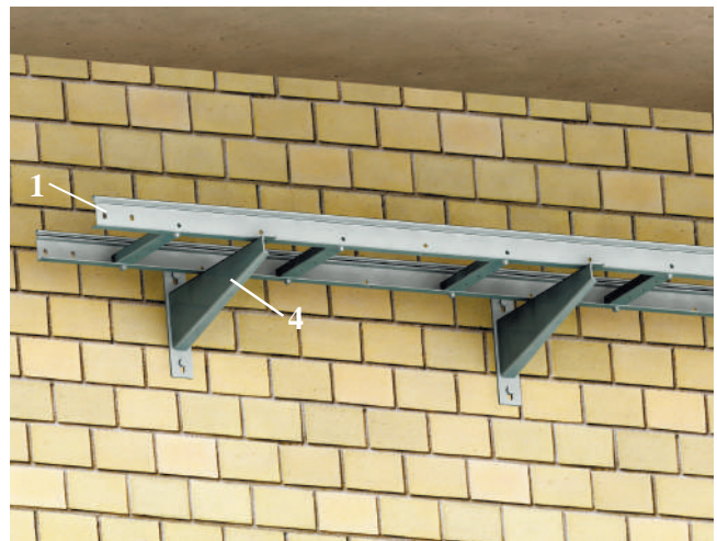
Монтаж опор к стене на консолях монолитных
